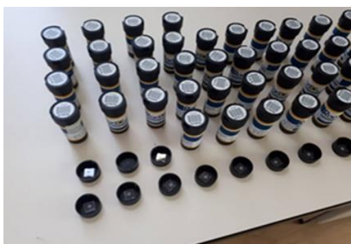
Снимка 6. Детектори тип RSKS – затворени и разглобени (ляво) и Микроскоп и софтуер за обработка на данните (дясно)
