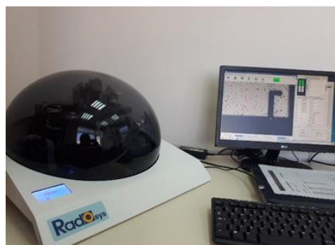
Снимка 6. Детектори тип RSKS – затворени и разглобени (ляво) и Микроскоп и софтуер за обработка на данните (дясно)
